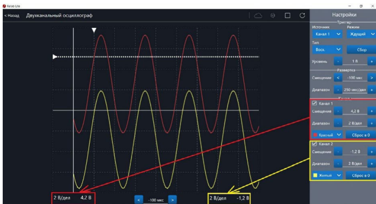
Рис. 39. Использование блока Каналы
